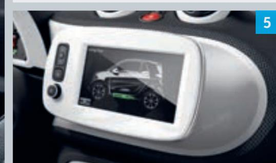
5 **Die Verbrauchsdetails zum Energiefluss** zeigen Ihnen in Ein-Minuten-Schritten an, wie viel Energie Sie verbraucht bzw. durch Rekuperation zurückgewonnen haben.
