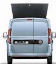
Nyitható rakodótér-tető („zsiráftető”), (opc. 585) két kifelé nyíló üvegezett vagy lemezelt hátsó ajtóval rendelhető
