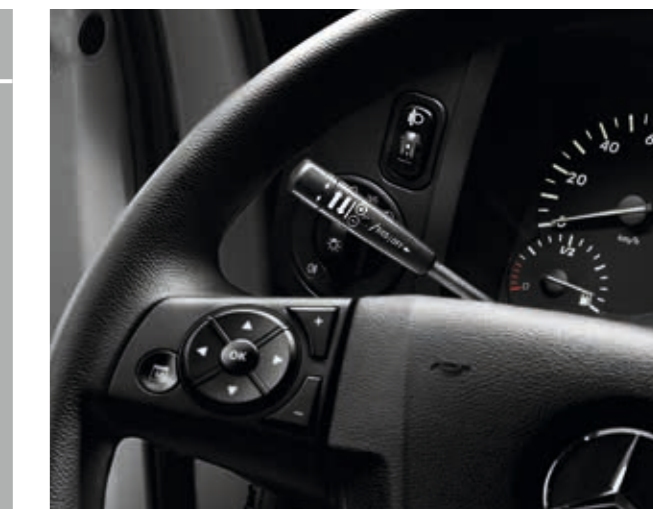
Neuer Lenkstockhebel: Mit der linken Hand können Anwender Fahrtrichtung, Gang und Tempomat bedienen – und haben die rechte Hand zum Beispiel für Geräte-Stellbewegungen mit dem Multifunktions-Joystick frei.
