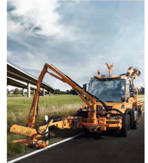
Mit seinen Hydrauliksystemen erledigt der Unimog mit Trio-Mähkombination bis zu drei Arbeitsgänge in einem.
