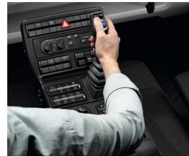
Vereinfachte und intuitive Gerätesteuerung mit dem neuen entnehmbaren Multifunktions-Joystick.
