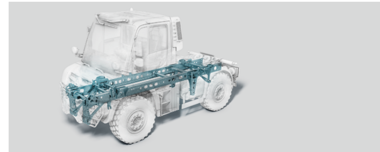
Vier An- und Aufbauträume: Der Unimog Geräteträger ist eine der produktivsten Arbeitsmaschinen überhaupt. Dank standardisierter Schnittstellen können vielfältigste Geräte kombiniert und über 1.000 Anwendungen realisiert werden. Dazu gehören die Frontanbauplatte, Rahmenanbaupunkte, Anbaubeschläge an den Seiten und am Heck sowie Kugelpunkte am Pritschenzwischenrahmen.
