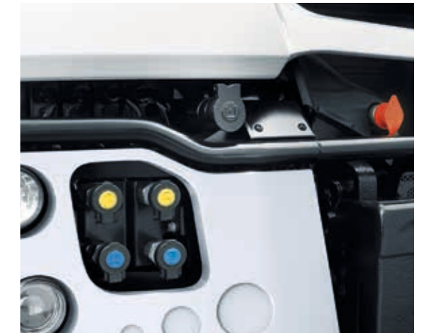
Hydraulikan Anschlüsse für bis zu vier Kreise befinden sich in geschützter Position an der Front und am Heck des Fahrzeugs.
