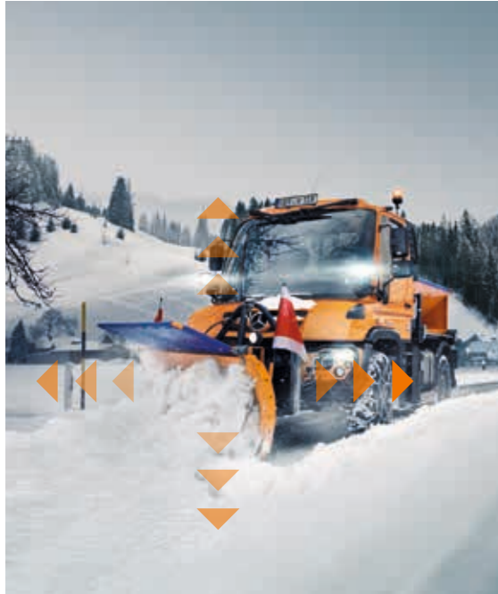
Selbst komplexe Bewegungen führt der neue Unimog schnell und feinfühlig durch. Die Schneepfluggentlastung verbessert die Traktion und reduziert den Verschleiß.
