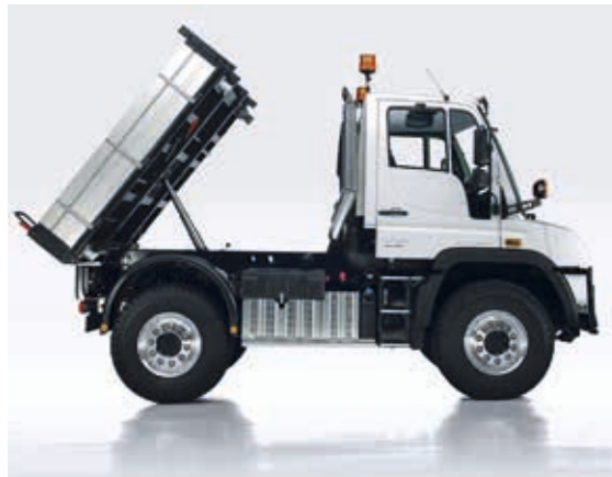
Die separate Kipphydraulik ermöglicht das von der Arbeitshydraulik unabhängige Kippen von Pritsche oder Anhängern.
