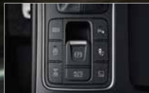
Üzemódválasztó rendszer (DMS) Egyetlen gombnyomással választhat a normál, eco, sport és smart üzem módok között. Mindegyik módosítja a hajtáslánc és a kormánymű reakcióidejét, hogy szükség esetén még kényel- mezebb és takarékosabb vagy élénkebb és sportosabb legyen az új Sorento.
