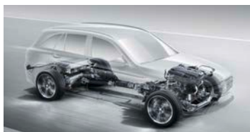
A 4MATIC összerék-hajtás minden helyzetben optimális tapadást tesz lehetővé. A nyomaték 45:55 arányban oszlik meg az első és hátsó tengely között.
