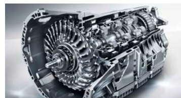
9G-TRONIC 9 fokozatú automata váltó. Elkápráztatja a még gyorsabb sebességváltásokkal és lágyabb kapcsolásokkal.
